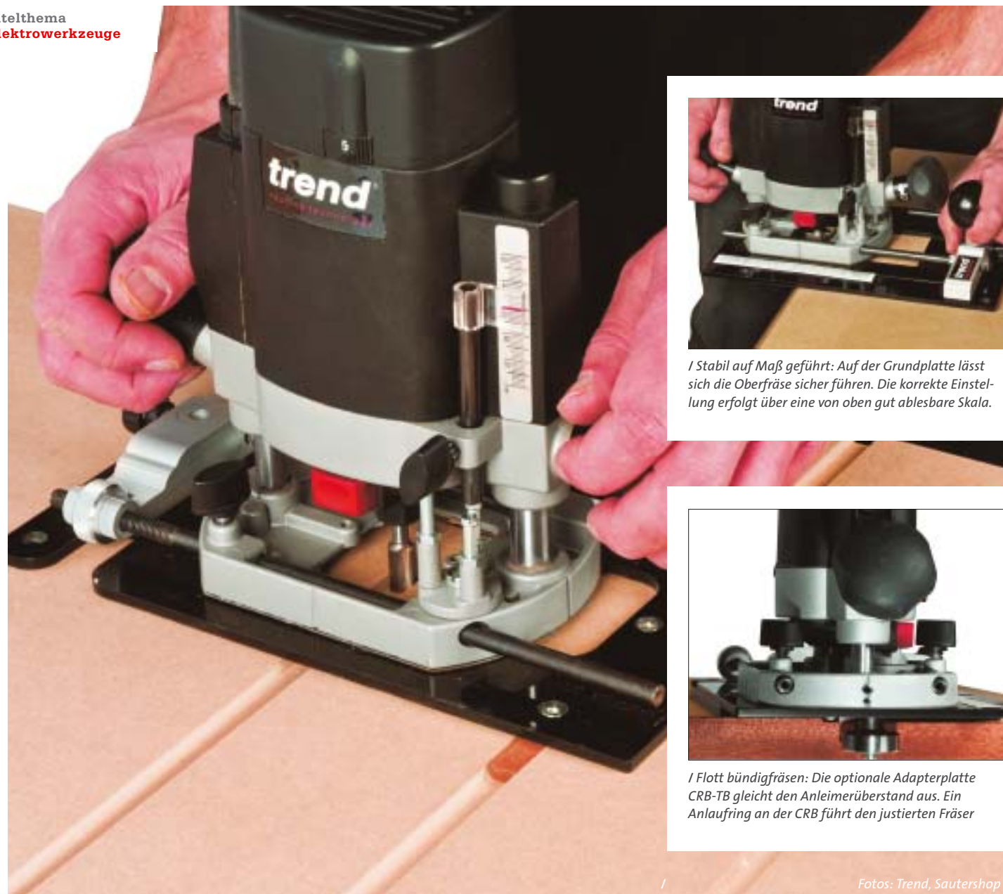
/ Einsatz in der Funktion als flexibler Parallelanschlag: So entstehen mir der Multifrässchablone durch Kopieren von Nuten, V-Nuten oder Hohlkehlen beispielsweise kreative Oberflächenstrukturen.
