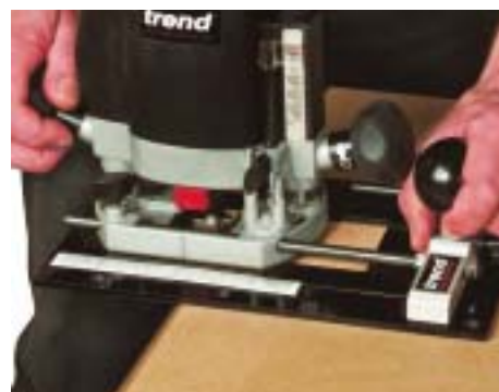
/ Stabil auf Maß geführt: Auf der Grundplatte lässt sich die Oberfräse sicher führen. Die korrekte Einstellung erfolgt über eine von oben gut ablesbare Skala.
