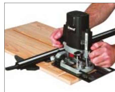
/ Rechtwinkig unterwegs: Entlang der Führungsschiene bleibt die Multifunktionsplatte samt Oberfräse immer geradeaus auf dem rechten Weg.
