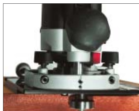
/ Flott bündigfräsen: Die optionale Adapterplatte CRB-TB gleicht den Anleimerüberstand aus. Ein Anlaufring an der CRB führt den justierten Fräser
