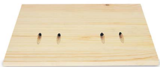
Edge to edge joints.
