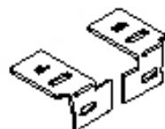
Nr. 2 Kantenführungen für die Fingerzinkenschablone einsetzen
